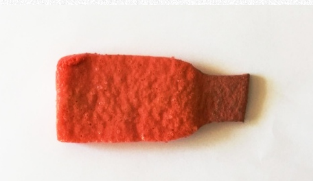
Профиль сечением 20x4мм (набухание через 72 часа)
