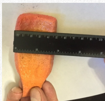
Размеры профиля 20x4 мм (набухание через 72 часа)
